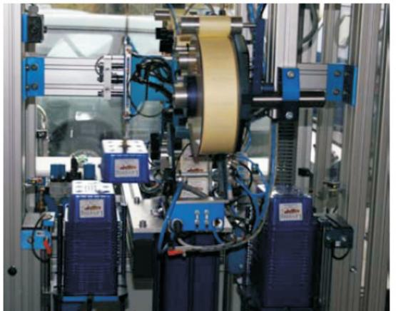
Die leeren Schalen werden im Stapel von unten zugeführt. Die Anlage verfügt über zwei Etikettenspender Micro 70, so dass die Etikettierung wahlweise auf eine oder beide Stirnseiten der Schale erfolgt. Nach erfolgter Etikettierung saugt eine Handlingseinheit die etikettierte Schale an und stapelt sie abwechselnd auf je einen Stapel links und rechts der Zuführung ab. Gleichzeitig wird die
