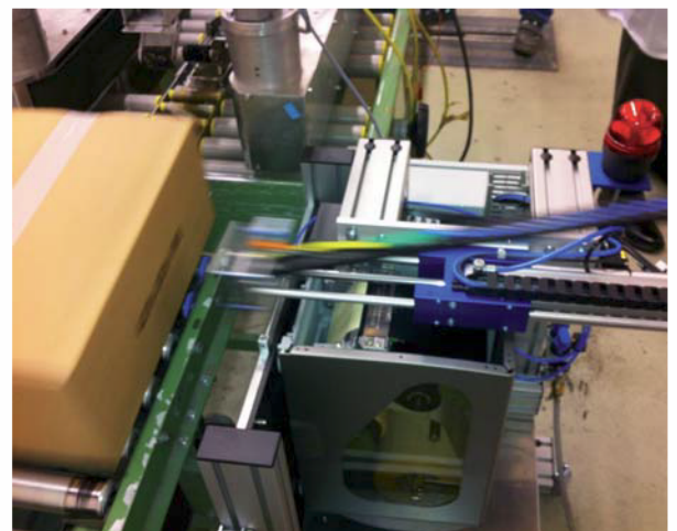
Der MCA3500 von Dalektron etikettiert im Durchlauf Pakete und Paletten direkt an der Produktionslinie.
