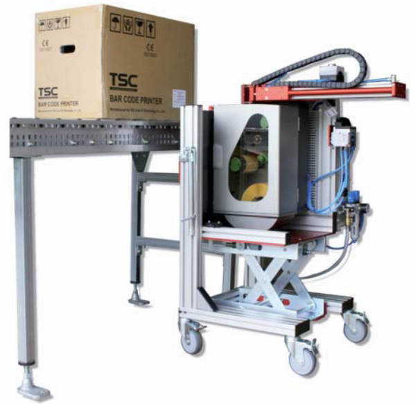
Der lange Hubarm und ein pneumatischer Vakuumstempel bringen die von einem Thermo-transferdrucker erzeugten Etiketten seitlich auf den Kartons an.
